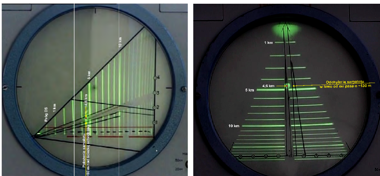
Fot. 29. Zobrazowanie pozycji samolotu względem ścieżki schodzenia i osi DS na wskaźnikach WISP-75
