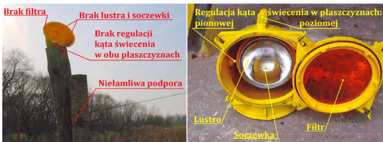
Fot. 24. Porównanie lamp systemu świetlnego z lewej – lampa systemu świetlnego na lotnisku SMOLEŃSK PÓŁNOCNY w dniu 10.04.2010 r. z prawej – lampa systemu świetlnego ŁUCZ-2MU
